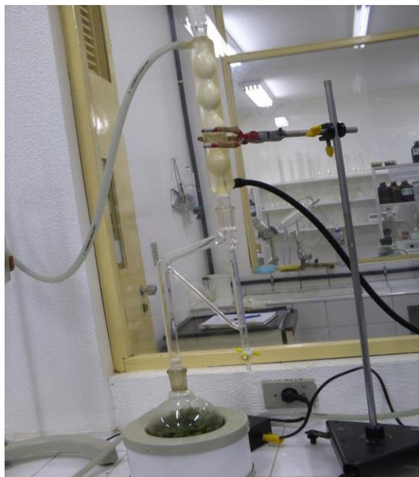
**Figura 5:** Aparelho tipo Clevenger modificado por Gottlieb.
